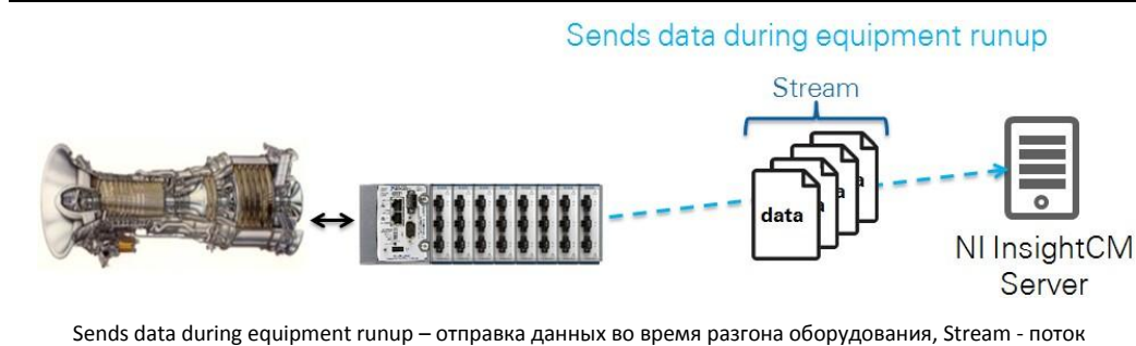
Рисунок 2-54. Пример пуска оборудования
